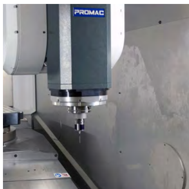
Sonda misura pezzo Touch probe
