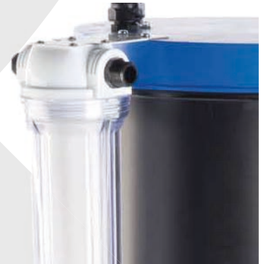
3 - Der Sicherheitsfilter (inklusive Gehäuse, Befestigung, Anschlußsystem) mit transparentem Schauglas zeigt Filtrationsdefizite an und sichert die Deionisation gegen Standzeitreduzierungen ab (z.B. bei groben Filtern oder Filterplatzern). Das spart bares Geld! Der Sicherheitsfilter gehört zur Erstaustattung.
